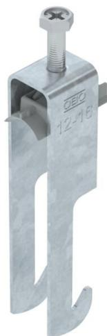
Bügel­schelle mit W-Fuß, Kunststoffdruckwanne aus Polypropylen. Zur vertikalen und horizontalen Montage von 2 Einzelkabeln an Winkeleisen bis < 40 mm. Mit 1-gängiger Schraube an Druckwanne, universeller Sechskant-Schraubenkopf SW10, mit Schlitz und Kreuzschlitz. Geeignet für Montage im Innen- und Außenbereich. Mehrere Kabel sollten durch Doppelwannen getrennt werden. Der Einsatz einer Gegenwanne wird empfohlen.
