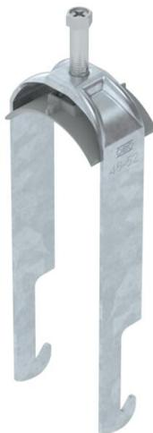
Bügel­schelle mit W-Fuß, Kunststoffdruckwanne aus Polypropylen. Zur vertikalen und horizontalen Montage von 2 Einzelkabeln an Winkeleisen bis < 40 mm. Mit 1-gängiger Schraube an Druckwanne, universeller Sechskant-Schraubenkopf SW10, mit Schlitz und Kreuzschlitz. Geeignet für Montage im Innen- und Außenbereich. Mehrere Kabel sollten durch Doppelwannen getrennt werden. Der Einsatz einer Gegenwanne wird empfohlen.
