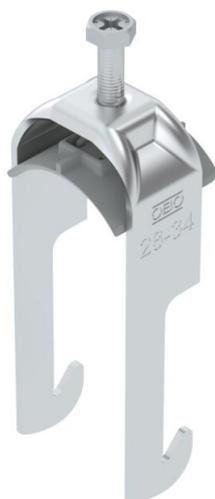
Bügelschelle mit W-Fuß, Kunststoffdruckwanne aus Polypropylen. Zur vertikalen und horizontalen Montage von 1 Einzelkabel an Winkeleisen bis < 40 mm. Mit 1-gängiger Schraube an Druckwanne, universeller Sechskant-Schraubenkopf SW10, mit Schlitz und Kreuzschlitz. Geeignet für Montage im Innen- und Außenbereich. Der Einsatz einer Gegenwanne wird empfohlen.
