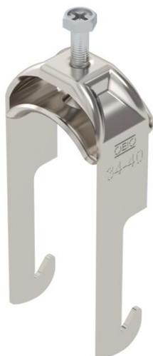
Bügelschelle mit W-Fuß, Metalldruckwanne mit gerundeten Kanten für Kabelschutz. Zur vertikalen und horizontalen Montage von 1 Einzelkabel an Winkelisen bis < 40 mm. Mit 1-gängiger Schraube an Druckwanne, universeller Sechskant-Schraubenkopf SW10, mit Schlitz und Kreuzschlitz. Geeignet für Montage im Innen- und Außenbereich. Der Einsatz einer Gegenwanne wird empfohlen.
