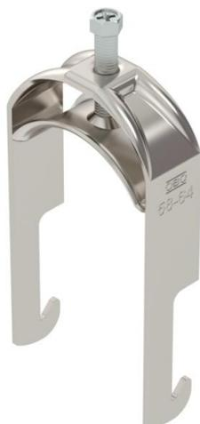
Bügelschelle mit W-Fuß, Metalldruckwanne mit gerundeten Kanten für Kabelschutz. Zur vertikalen und horizontalen Montage von 1 Einzelkabel an Winkelisen bis < 40 mm. Mit 1-gängiger Schraube an Druckwanne, universeller Sechskant-Schraubenkopf SW10, mit Schlitz und Kreuzschlitz. Geeignet für Montage im Innen- und Außenbereich. Der Einsatz einer Gegenwanne wird empfohlen.
