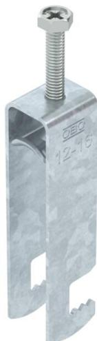
Bügelshelle mit F-Fuß, Metalldruckwanne mit gerundeten Kanten für Kabelschutz. Zur vertikalen und horizontalen Montage von 3 Einzelkabeln an Flacheisen. Mit 1-gängiger Schraube an Druckwanne, universeller Sechskant-Schraubenkopf SW10, mit Schlitz und Kreuzschlitz. Geeignet für Montage im Innen- und Außenbereich. Mehrere Kabel sollten durch Doppelwannen getrennt werden. Der Einsatz einer Gegenwanne wird empfohlen.
