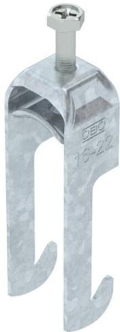
Bügelschelle mit W-Fuß, Metalldruckwanne mit gerundeten Kanten für Kabelschutz. Zur vertikalen und horizontalen Montage von 1 Einzelkabel an Winkelisen bis < 40 mm. Mit 1-gängiger Schraube an Druckwanne, universeller Sechskant-Schraubenkopf SW10, mit Schlitz und Kreuzschlitz. Geeignet für Montage im Innen- und Außenbereich. Der Einsatz einer Gegenwanne wird empfohlen.
