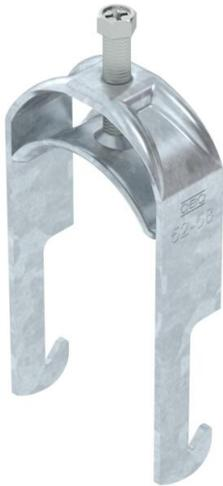
Bügelschelle mit W-Fuß, Metalldruckwanne mit gerundeten Kanten für Kabelschutz. Zur vertikalen und horizontalen Montage von 1 Einzelkabel an Winkelleisen bis < 40 mm. Mit 1-gängiger Schraube an Druckwanne, universeller Sechskant-Schraubenkopf SW10, mit Schlitz und Kreuzschlitz. Geeignet für Montage im Innen- und Außenbereich. Der Einsatz einer Gegenwanne wird empfohlen.
