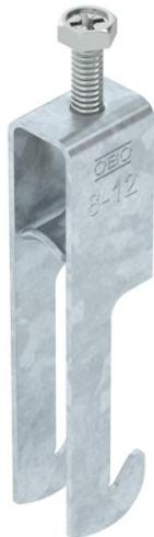
Bügel­schelle mit W-Fuß, Metall­druckwanne mit gerundeten Kanten für Kabel­schutz. Zur vertikalen und horizontalen Montage von 2 Einzelkabeln an Winkeleisen bis < 40 mm. Mit 1-gängiger Schraube an Druckwanne, universeller Sechskant-Schraubenkopf SW10, mit Schlitz und Kreuzschlitz. Geeignet für Montage im Innen- und Außenbereich. Der Einsatz einer Gegenwanne wird empfohlen.
