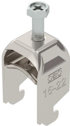
Bügel­schelle mit N-Fuß, Metall­druckwanne mit gerundeten Kanten für Kabel­schutz. Zur vertikalen und horizontalen Montage von 1 Einzelkabel an C-Profil­schiene. Für Schlitzweite 11 - 12 mm. Mit 1-gängiger Schraube an Druckwanne, universeller Sechskant-Schraubenkopf SW10, mit Schlitz und Kreuzschlitz. Ge­eignet für Montage im Innen- und Außenbereich. Der Einsatz einer Gegenwanne wird empfohlen.
