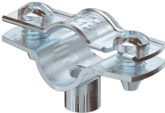
Abstandschelle zur Montage von Rohren und Kabeln an Wand, Decke und Boden. Mit selbstsicherndem Oberteil. Befestigung über Ansatz mit Innengewinde. Oberflächen G und FT ab Schellengröße 20 geeignet für Montage mit Nagelgerät oder Bolzensetzgerät. Zugelassen für den Funktionserhalt nach DIN 4102 Teil 12, Funktionserhaltklassen E 30 bis E 90.
