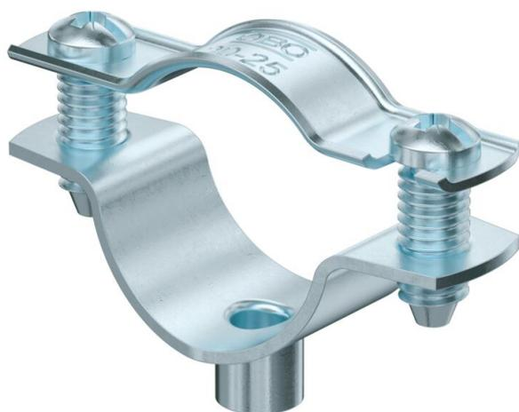
Abstandschele zur Montage von Röhren und Kabeln an Wand, Decke und Boden. Mit selbstsicherndem Oberteil. Befestigung über Ansatz mit Innengewinde. Zugelassen für den Funktionserhalt nach DIN 4102 Teil 12, Funktionserhaltklassen E 30 bis E 90.
