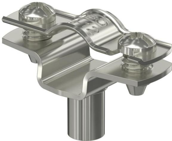
Abstandschele zur Montage von Rohren und Kabeln an Wand, Decke und Boden. Mit selbstsicherndem Oberteil. Befestigung über Ansatz mit Innengewinde. Oberflächen G und FT ab Schellengröße 20 geeignet für Montage mit Nagelgerät oder Bolzensetzgerät. Zugelassen für den Funktionserhalt nach DIN 4102 Teil 12, Funktionserhaltklassen E 30 bis E 90.
