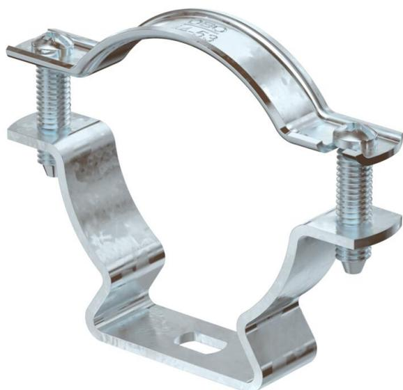
Abstandschele zur Montage von Rohren und Kabeln an Wand, Decke und Boden. Mit selbstsicherndem Oberteil. Befestigung über Langloch. Zugelassen für den Funktionserhalt nach DIN 4102 Teil 12, Funktionserhaltklassen E 30 bis E 90.
