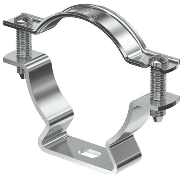
Abstandschelle zur Montage von Rohren und Kabeln an Wand, Decke und Boden. Mit selbstsicherndem Oberteil. Befestigung über Langloch. Ab der Schellengröße 20 geeignet für Montage mit Nagelgerät oder Bolzensetzgerät. Zugelassen für den Funktionserhalt nach DIN 4102 Teil 12, Funktionserhaltklassen E 30 bis E 90 (außer ALU).
