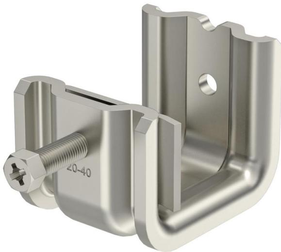
Diese Art Trägerklammer wird auf den Träger aufgeschoben und mittels einer Druckwanne und Schraube (M8) am Träger oder Flacheisen fixiert. Die Sechskantschraube hat eine Schlüsselweite von 10 mm. Im Schellenkörper sind außerdem zwei weitere M8 Gewinde eingebracht, um zum Beispiel Gewindestangen zu befestigen.
