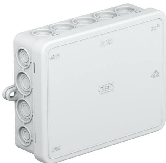
Schutzart IP55, Nennspannung 690 V, Nennquerschnitt 2,5 mm<sup>2</sup>, 10 Einführungen für Kabeldurchmesser 5-14 mm
