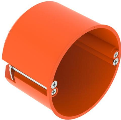
CEE/PERILEX-Hohlwand-Gerätedose für den Einsatz in Hohlwänden mit einer Einbautiefe von mindestens 61 mm und einer Plattenstärke von 5 - 40 mm.
