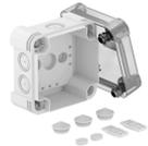
Kabelabzweigkasten zum Verbinden von Kabeln und Leitungen im Innen- und Außenbereich. Quadratische Form mit Ausschlageinführungen. Geeignet für die Wand-/ Deckenmontage mit der Möglichkeit zur Außenbefestigung, Innenbefestigung oder Montage über die Eckdome. Besonders schlagfest mit IK09. Transparenter Deckel mit Schnellverschluss, plombierbar. Hergestellt aus halogenfreien und UV-resistenten Materialien.
