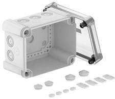
Kabelabzweigkasten zum Verbinden von Kabeln und Leitungen im Innen- und Außenbereich. Rechteckige Form mit Ausschlageinführungen. Geeignet für die Wand-/ Deckenmontage mit der Möglichkeit zur Außenbefestigung, Innenbefestigung oder Montage über die Eckdome. Besonders schlagfest mit IK09. Transparenter Deckel mit Schnellverschluss, plombierbar. Hergestellt aus halogenfreien und UV-resistenten Materialien.
