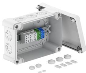
Kabelabzweigkasten zum Verbinden von Kabeln und Leitungen im Innen- und Außenbereich. Rechteckige Form mit Ausschlageinführungen. Geeignet für die Wand-/ Deckenmontage mit der Möglichkeit zur Außenbefestigung, Innenbefestigung oder Montage über die Eckdome. Besonders schlagfest mit IK09. Deckel mit Schnellverschluss, plombierbar. Hergestellt aus halogenfreien und UV-beständigen Materialien.
