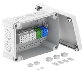
Kabelabzweigkasten zum Verbinden von Kabeln und Leitungen im Innen- und Außenbereich. Rechteckige Form mit Ausschlageinführungen. Geeignet für die Wand-/ Deckenmontage mit der Möglichkeit zur Außenbefestigung, Innenbefestigung oder Montage über die Eckdome. Besonders schlagfest mit IK08. Deckel mit Schnellverschluss, plombierbar. Hergestellt aus halogenfreien und UV-resistenten Materialien.
