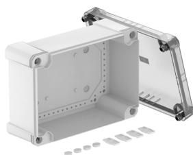
Kabelabzweigkasten zum Verbinden von Kabeln und Leitungen im Innen- und Außenbereich. Rechteckige Form ohne Einführungen. Geeignet für die Wand-/Deckenmontage mit der Möglichkeit zur Außenbefestigung, Innenbefestigung oder Montage über die Eckdome. Besonders schlagfest mit IK09. Transparenter Deckel mit Schnellverschluss, plombierbar. Hergestellt aus halogenfreien und UV-resistenten Materialien.
