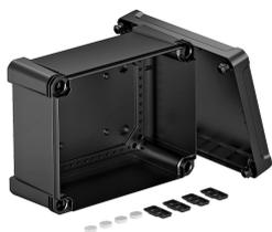
Kabelabzweigkasten zum Verbinden von Kabeln und Leitungen im Innen- und Außenbereich. Rechteckige Form ohne Einführungen. Geeignet für die Wand-/Deckenmontage mit der Möglichkeit zur Außenbefestigung, Innenbefestigung oder Montage über die Eckdome. Besonders schlagfest mit IK09. Deckel mit Schnellverschluss, plombierbar. Hergestellt aus halogenfreien und UV-resistenten Materialien.
