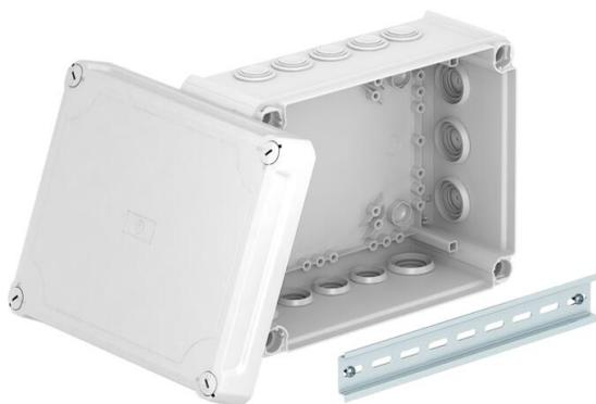
Kabelabzweigkasten zum Verbinden von Kabeln und Leitungen im Innenbereich und geschützten Außenbereichen. Rechteckige Form mit Einsteckdichtungen an den Seiten und Ausschlageinführungen im Boden. Geeignet für die Wand-/ Deckenmontage, die Montage auf Montageblechen und Gewinde im Boden. Mit der Möglichkeit zur Innenbefestigung und Montage über die Eckdome. Hoher Deckel mit Schnellverschluss, plombierbar. Hergestellt aus halogenfreien und UV-resistenten Materialien.
