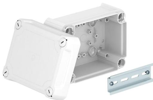
Kabelabzweigkasten geschlossen zum Verbinden von Kabeln und Leitungen im Innenbereich und geschützten Außenbereichen. Rechteckige Form ohne Einführungen. Geeignet für die Wand-/ Deckenmontage und die Montage auf Montageblechen. Mit der Möglichkeit zur Innenbefestigung und Montage über die Eckdo-me. Hoher Deckel mit Schnellverschluss, plombierbar. Hergestellt aus halogen-freien und UV-resistenten Materialien.
