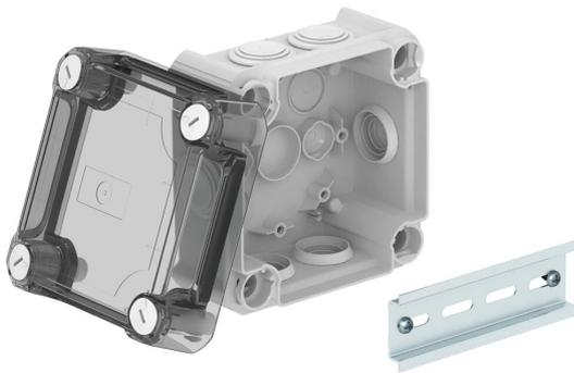
Kabelabzweigkasten zum Verbinden von Kabeln und Leitungen im Innenbereich und geschützten Außenbereichen. Quadratische Form mit Einsteckdichtungen an den Seiten und Ausschlageinführungen im Boden. Geeignet für die Wand-/Deckenmontage und die Montage auf Montageblechen. Mit der Möglichkeit zur Innenbefestigung und Montage über die Eckdome. Hoher, transparenter Deckel mit Schnellverschluss, plombierbar. Hergestellt aus halogenfreien und UV-resistenten Materialien.
