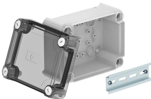
Kabelabzweigkasten geschlossen zum Verbinden von Kabeln und Leitungen im Innenbereich und geschützten Außenbereichen. Rechteckige Form ohne Einführungen. Geeignet für die Wand-/ Deckenmontage und die Montage auf Montageblechen. Mit der Möglichkeit zur Innenbefestigung und Montage über die Eckdomme. Hoher, transparenter Deckel mit Schnellverschluss, plombierbar. Hergestellt aus halogenfreien und UV-resistenten Materialien. Inklusive Hutprofilschiene.
