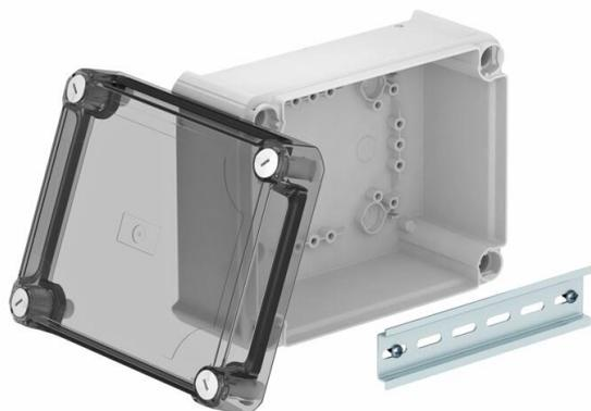
Kabelabzweigkasten geschlossen zum Verbinden von Kabeln und Leitungen im Innenbereich und geschützten Außenbereichen. Rechteckige Form ohne Einführungen. Geeignet für die Wand-/ Deckenmontage und die Montage auf Montageblechen. Mit der Möglichkeit zur Innenbefestigung und Montage über die Eckdomme. Hoher, transparenter Deckel mit Schnellverschluss, plombierbar. Hergestellt aus halogenfreien und UV-resistenten Materialien. Inklusive Hutprofilschiene.
