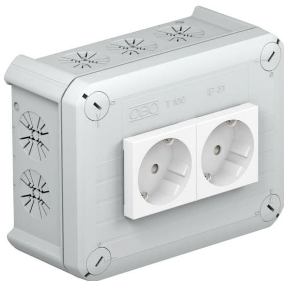
Kabelabzweigkasten zum Verbinden von Kabeln und Leitungen im Innenbereich und geschützten Außenbereichen. Rechteckige Form mit Ausschlageinführungen an den Seiten und Ausschlageinführungen im Boden. Geeignet für die Wand-/ Deckenmontage und die Montage auf Montageblechen. Mit der Möglichkeit zur Innenbefestigung und Montage über die Eckdome. Deckel mit Schnellverschluss, plombierbar mit Verliersicherung und 2 Modul45-Steckdosen. Hergestellt aus halogenfreien und UV-resistenten Materialien.
