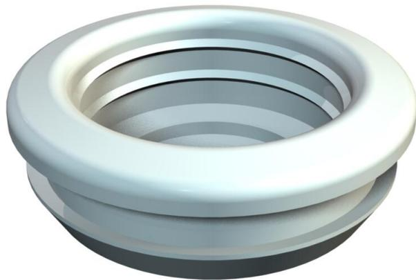
Geschlossener Einführungsrippel mit Durchstoßmembrane für Kabeldurchmesser 12 - 16 mm. Ideal zur einfachen Kabel und Leitungseinführung in Gehäusen oder durch dünnwandige Bleche.
