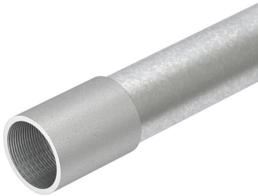
Elektroinstallationsrohr nach EN 61386-1, mit Gewindeenden nach DIN EN 60423, für den mechanischen Schutz von Kabeln und Leitungen. Mit gratfreier Innenwand. Korrosionsschutzklasse 4 (hoch). Pro Rohr ist bereits eine Verbindungsmuffe aufgeschraubt.
