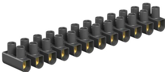
Geprüft nach EN 60998. Klemmen Stahl, Schrauben Stahl, galvanisch verzinkt, 12-polige, in Einzelklemmen abtrennbare Leisten durch "twist'n'pull". Schrauben hochgedreht, unverlierbar. Max. zulässige Umgebungstemperatur gemäß EN 60998: -5 bis +80 °C. Nennquerschnitt 10 + mm<sup>2</sup> Nennspannung 450 V Nennstrom 57 A Max. klemmbar je Seite: 10 mm<sup>2</sup> eindrätig oder 6 mm<sup>2</sup> mehrdrätig/flexibel.
