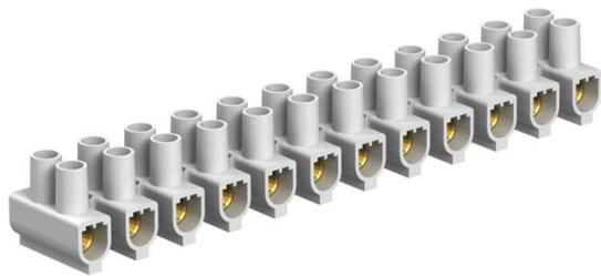
Geprüft nach EN 60998. Klemmen Messing, Schrauben Stahl, galvanisch verzinkt und transparent passiviert, 12-polige, in Einzelklemmen abtrennbare Leisten. Schrauben hochgedreht, unverlierbar. Max. zulässige Umgebungstemperatur gemäß EN 60998: -5 bis +80 °C. Nennquerschnitt 25 ± mm<sup>2</sup> Nennspannung 750 V Nennstrom 101 A Max. klemmbar je Seite: 25 mm<sup>2</sup> mehrdrähtig oder 16 mm<sup>2</sup> feindrähtig.
