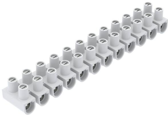
Geprüft nach EN 60998. Klemmen Stahl, Schrauben Stahl, galvanisch verzinkt, 12-polige, in Einzelklemmen abtrennbar Leisten durch "twist'n'pull". Schrauben hochgedreht, unverlierbar. Max. zulässige Umgebungstemperatur gemäß EN 60998: -5 bis +80 °C. Nennquerschnitt 10 ÷ mm<sup>2</sup> Nennspannung 450 V Nennstrom 57 A Max. klemmbar je Seite: 10 mm<sup>2</sup> starr oder 6 mm<sup>2</sup> flexibel.
