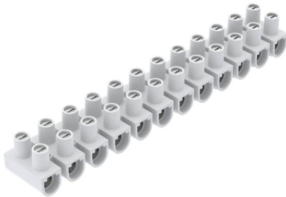
Geprüft nach EN 60998. Klemmen Stahl, Schrauben Stahl, galvanisch verzinkt, 12-polige, in Einzelklemmen abtrennbar Leisten durch "twist'n'pull". Schrauben hochgedreht, unverlierbar. Max. zulässige Umgebungstemperatur gemäß EN 60998: -5 bis +80 °C. Nennquerschnitt 16 ÷ mm<sup>2</sup> Nennspannung 450 V Nennstrom 76 A Max. klemmbar je Seite: 16 mm<sup>2</sup> starr oder 10 mm<sup>2</sup> flexibel bzw. 6 mm<sup>2</sup> flexibel.
