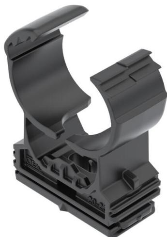
Hochbelastbare Schelle zur Aufnahme von Elektro- und Sanitärrohren aus Kunststoff und Metall sowie Elektroinstallationsrohr Quick-Pipe. Universelle Befestigungsmöglichkeiten an Wand, Decke und Stahlkonstruktionen im Innen- und Außenbereich. Flexibler Spannungsbereich von mehreren Millimetern. Werkzeuglose Rohrmontage. Aneinander reihbar bis Ø 32 mm, auch mit OBO Quick- oder Multi-Quick-Schelle. Für variable Abstände und Schellenanzahl montierbar auf Profilschiene.
