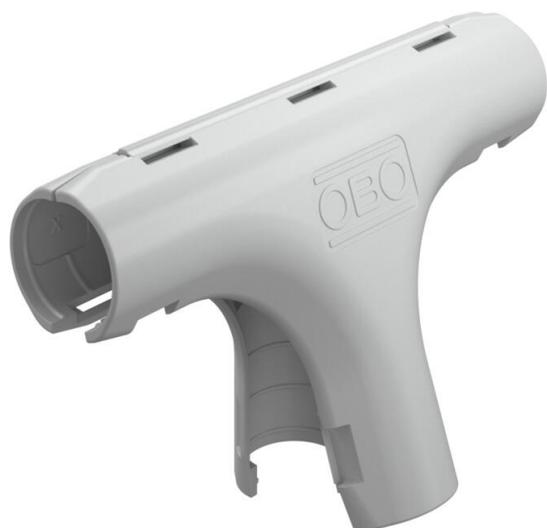
Formteil für Elektroinstallationsrohre aus Kunststoff zum Erstellen von T-Abzweigen. Geeignet für Rohr Quick-Pipe® oder Wellrohre. Werkzeugloses Verschließen und Öffnen. Einsetzbar im Temperaturbereich von - 25° bis + 60° C.
