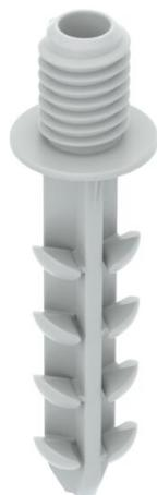
Steckdübel Delta-Push® zur Montage in der Elektroinstallation. Geeignet für Beton, Kalksandstein, Vollziegel, Hohllochziegel und Porenbeton. Werkzeuglose Montage durch Eindrücken in Bohrloch an Wand oder Decke. Ohne Schrauben. Mit M6-Gewinde zum Aufschrauben von z. B. Quick-Schellen.
