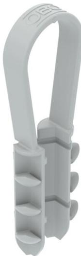
Steckdübel zum Montieren von leichten Lasten in der Elektroinstallation. Geeignet für Beton, Kalksandstein, Vollziegel, Hohllochziegel und Porenbeton. Werkzeuglose Montage durch Eindrücken in Bohrloch an Wand oder Decke. Ohne Schrauben. Mit wiederverschließbarer Schlaufe zur Befestigung von Kabeln.
