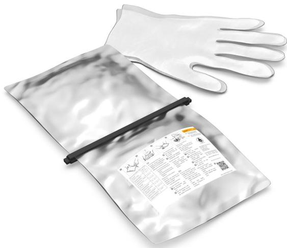
Zwei-Komponenten-Vergussmasse Aquasit im Aluminiumbeutel, zum Verfüllen von Kabelabzweigkästen in Außenbereichen mit extrem hoher und langanhaltender Feuchtigkeit. Auch einsetzbar bei mechanischem Schock. Verarbeitungszeit von 20 Minuten nach Öffnen und Vermischen. Bis zu 24 Monate nach Produktionsdatum ungeöffnet lagerbar bei 0 bis 40 °C. Erfahrungen, Prüfungen und Bestätigungen gelten nur in Verbindung mit OBO-Kabelabzweigkästen.
