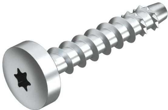
Schraubanker zur direkten Montage ohne Dübel in gerissenem und ungerissenem Beton sowie Mauerwerk. Mit Rundkopf für universelle Befestigungen. Torx-Antrieb T30.
