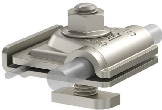
Vormontierte Erdungsklemme zum Einbinden von PV-Montagesystemen in den Potentialausgleich. Geeignet zur Einbindung der PV-Montagesystemen in ein äußeres Blitzschutzsystem.
