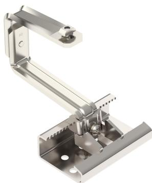
Dachhaken zum Montieren von Photovoltaik-Modulen auf Schrägdächern in Kombination mit Trägerprofil TP 45. Geeignet für Ziegeldächer. Schraubbare Befestigung an Trägerprofil. Montage an Dachsparren mit Tellerkopfschrauben TKS. Dachhaken ist horizontal und vertikal über Verschraubungen stufenlos einstellbar, passender Schlüssel Torx 40. Höheneinstellung im Bereich der Dachlatte von 40-54 mm, seitliche Verstellmöglichkeit bis zu 76 mm, Höhenverstellung des Trägerprofils bis zu 18 mm.
