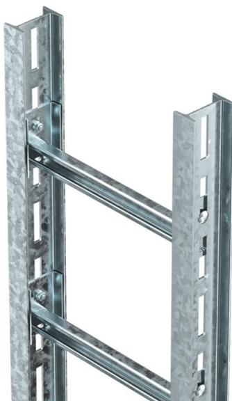
Industrie-Steigeleiter-System für den elektrischen Funktionserhalt nach DIN 4102 Teil 12. Zugelassene Schellen Typ BS-U1-M-... FT. Lieferung erfolgt unmontiert. Sprossenabstand 300 mm. Sprossen Typ CK 40/... und Schrauben Typ FRS 10 x 25 FT werden zu Holzprofilen unmontiert geliefert.
