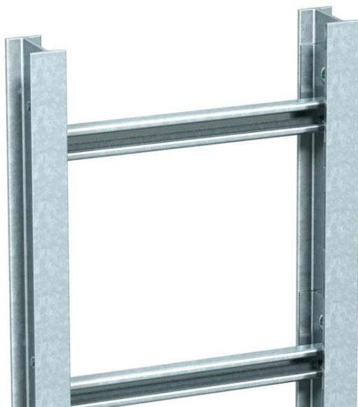
Industrie-Steigeleiter-System für den elektrischen Funktionserhalt nach DIN 4102 Teil 12. Zugelassene Schellen Typ BS-U1-M-... FT. Lieferung erfolgt unmontiert. Sprossenabstand 300 mm. Sprossen Typ CK 40/... und Schrauben Typ FRS 10 x 25 FT werden zu Holzprofilen unmontiert geliefert.
