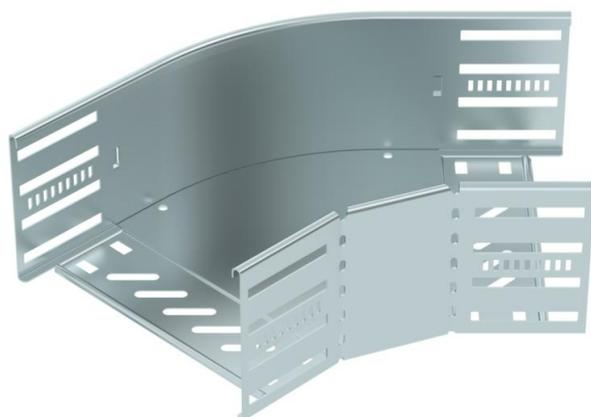
45°-Bogen zum Erstellen einer horizontalen Abzweigung, Formteil für rast- und schraubbare Kabelrinnen Seitenhöhe 110 mm. Schraubenlose Montage mit Doppelklemmen oder Schraubverbindung mit Flachrundschräuben FRS und Kombimuttern M6. Einsetzbar im Innenbereich. Befestigungsmaterial muss separat bestellt werden.
