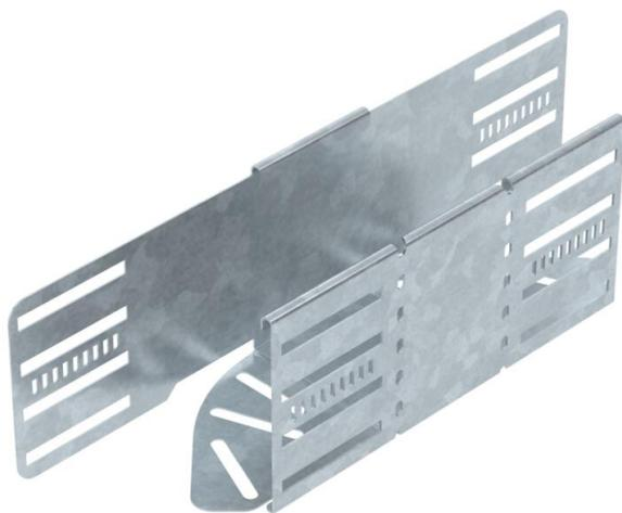
Winkelverstellbarer Bogen zum Erstellen einer horizontalen Abzweigung. Formteil für rast- und schraubbare Kabelrinnen Seitenhöhe 110 mm. Einstellbarer Winkel 0 - 90°. Schraubenlose Montage mit Doppelklemmen oder Schraubverbindung mit Flachrundschrauben FRS und Kombimuttern M6. Einsetzbar im Innen- und Außenbereich. Befestigungsmaterial muss separat bestellt werden.
