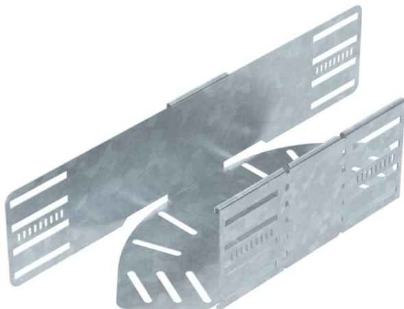
Winkelverstellbarer Bogen zum Erstellen einer horizontalen Abzweigung. Formteil für rast- und schraubbare Kabelrinnen Seitenhöhe 110 mm. Einstellbarer Winkel 0 - 90°. Schraubenlose Montage mit Doppelklemmen oder Schraubverbindung mit Flachrundschrauben FRS und Kombimuttern M6. Einsetzbar im Innen- und Außenbereich. Befestigungsmaterial muss separat bestellt werden.
