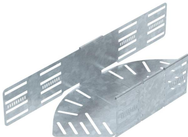
Winkelverstellbarer Bogen zum Erstellen einer horizontalen Abzweigung. Formteil für rast- und schraubbare Kabelrinnen Seitenhöhe 110 mm. Einstellbarer Winkel 0 - 90°. Schraubenlose Montage mit Doppelklemmen oder Schraubverbindung mit Flachrundschrauben FRS und Kombimuttern M6. Einsetzbar im Innen- und Außenbereich. Befestigungsmaterial muss separat bestellt werden.
